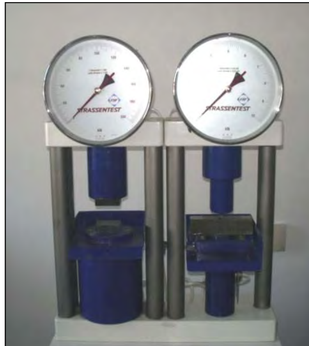
Biegezug- und Druckprüfmaschine der Firma STRASSENTEST
