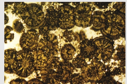
Dünnschlifffoto von einem Oolithkalkstein
