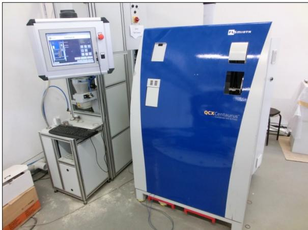
**Abbildung 1: Der Centaurus von FLSmidth zur vollautomatischen Probenpräparation (hier abgebildet das Vorgängermodell zum neu entwickelten Prototypen V2).**
