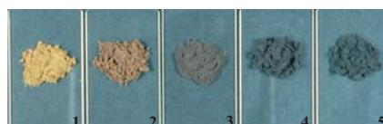
Abb. 6: Farbänderung der Ferratphase bei  $\text{Mn}^{3+}$ -Einbau. Mischkristallreihe  $\text{C}_6\text{A}_2\text{F}-\text{C}_6\text{A}_2\text{Mn}$
